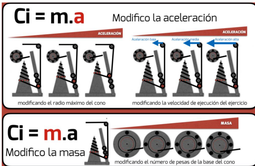
Ilustración 11: modificación masa y aceleración polea cónica
