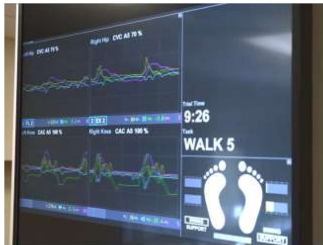
Figura 6: registro de EMG, cambio de cargas y tiempo durante la utilización del exoesqueleto HAL® (65).
