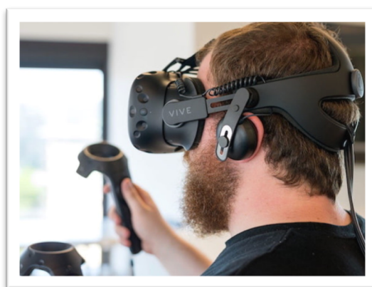
Figura 3: Participant utilitzant el material del HTC Vive (comandaments i ulleres de RV).
