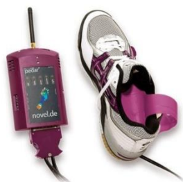
Fig.3. Sistema de monitorización de presiones del pie, Pedar-X (Novel, Munich, Germany).
