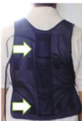
Fig.4. Dos sets de acelerómetros triaxiales asegurados con un chaleco a la espalda del individuo (Shinichi, 2019)
